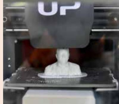
In der Offenen Werkstatt Hagen demonstriert das Kompetenzzentrum eStandards die Schnittstellenproblematik einer Fertigungslinie live anhand eines 3D-Scans, seiner digitalen Bearbeitung und Extrusions-3D-Druck.
