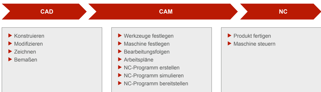
Abbildung: Die CAD-CAM-NC-Kette
